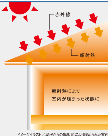
イメージイラスト/屋根からの輻射熱により暖められた室内
